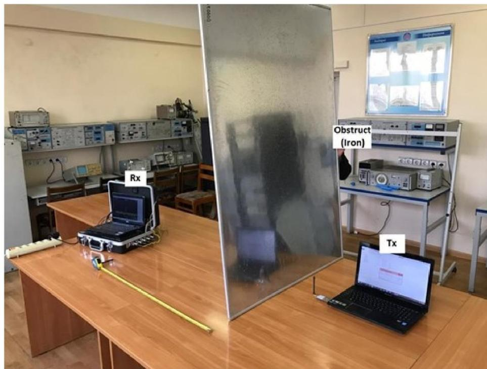
Рисунок 20. Экспериментальная установка генератора и приемного анализатора спектра для измерения значения принятого сигнала при не прямой видимости (NLOS) при наличии преграды из железа
