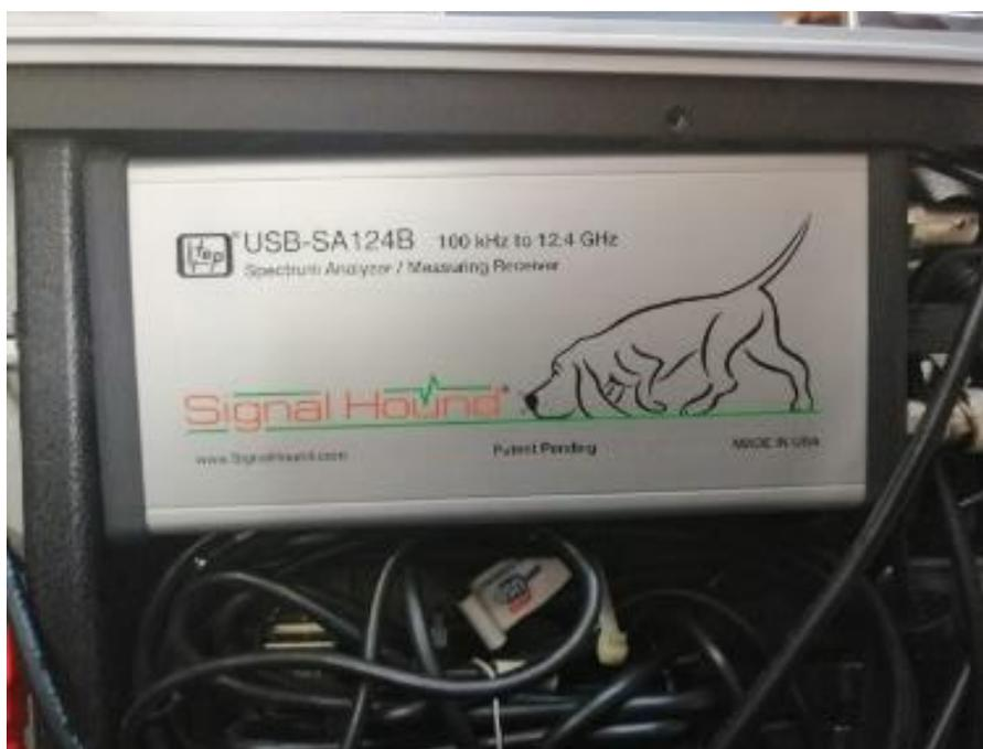
Рисунок 5 – Модуль анализатора спектра USB-SA124B (100 кГц-12.4 ГГц)
