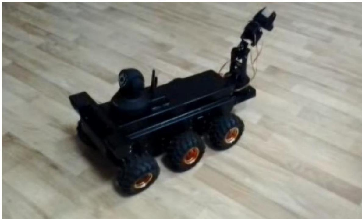
Рисунок 51. Роботизированное транспортное средство с возможностью передвигаться автономно
