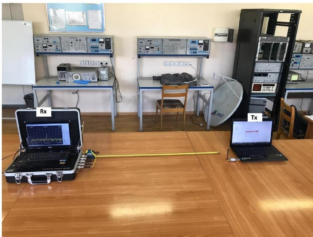
Рисунок 18. Экспериментальная установка генератора и приемного анализатора спектра для измерения уровня принятого сигнала при прямой видимости (LOS)
