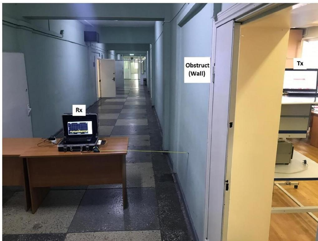
Рисунок 22. Экспериментальная установка генератора и приемного анализатора спектра для измерения принимаемого сигнала при не прямой видимости (NLOS) при наличии преграды в виде стены
